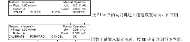
再按 Start 下的功能键开始以所设定的流速平衡层析柱,检查电脑软件中色谱图的 UV 基线。如果要以 A、B 两种溶液以一定配比平衡或冲洗层析柱,则在上述泵主界面按 Buffer 下的功能键进入溶液混合界面:
